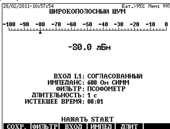
Когда выбранное время измерения равно 5 минут или дольше, результат отображается в виде гистограммы, а при нажатии клавиши **СПИСОК (F2)** результат появляется в численном виде. Чтобы получить обратно графическую форму, нажмите **ESC**.
